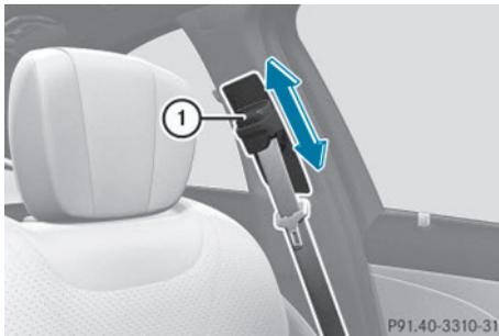
La partie supérieure de la ceinture de sécurité doit toujours passer sur le milieu de l'épaule. Si nécessaire, réglez le point de renvoi de la ceinture.
