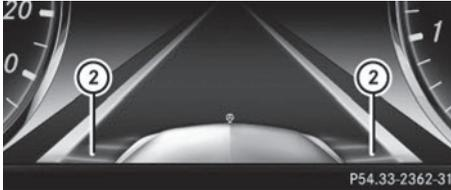
Si l'avertisseur actif d'angle mort est activé, des ondes radar grises se propageant vers l'arrière apparaissent à côté du véhicule sur le graphique du système d'aide du visuel multifonction. Lorsque vous roulez à plus de 20 mph (30 km/h), les ondes radar deviennent vertes sur le graphique du système d'aide ②. L'avertisseur actif d'angle mort est alors opérationnel.
