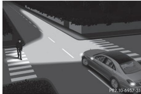
L'éclairage d'intersection augmente considérablement l'angle d'éclairage de la portion de route dans laquelle le véhicule s'engage et permet ainsi de mieux repérer les virages serrés, par exemple. Il peut uniquement être activé lorsque les feux de croisement sont allumés.
