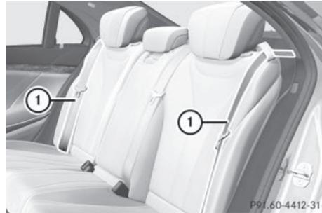
En cas de déclenchement, les airbags ceintures ① se déploient, augmentant ainsi la surface de maintien au niveau de la cage thoracique des occupants du véhicule. Ils se déclenchent en fonction de la nature et de la gravité de l'accident.
