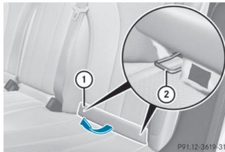
Les étriers de fixation ISOFIX (2) des sièges arrière sont recouverts d'une protection rembourrée (1) avec bande velcro.
