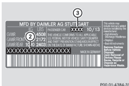
Plaque constructeur du véhicule (exemple - uniquement pour les Etats-Unis)
