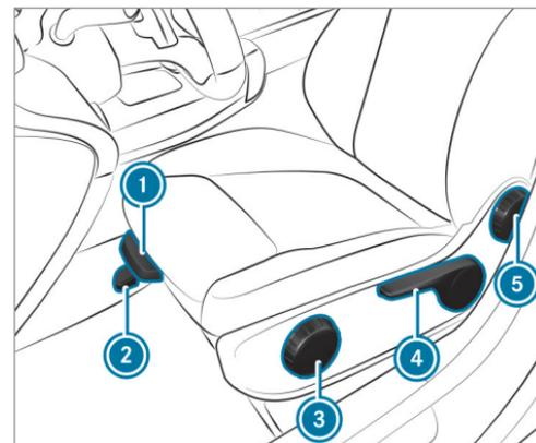
► **Réglage de la profondeur d'assise** : soulevez le levier ① et avancez ou reculez la partie avant du coussin d'assise.
