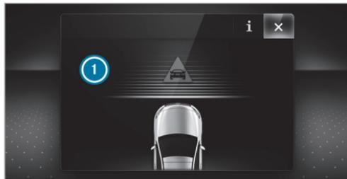
Lorsqu'un freinage autonome ou une assistance au freinage asservie à la situation a été déclenché, l'affichage ❶ apparaît sur l'écran multifonction, puis disparaît automatiquement après un court instant.
