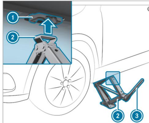
▶ Mettez le cric (2) en place sous le point d'appui (1).
