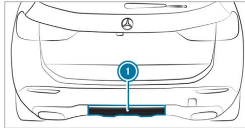
**1** Zone de détection des capteurs
