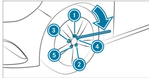
▶ Serrez les vis de roue uniformément dans l'ordre indiqué ① à ⑤, c'est-à-dire en diagonale, avec un couple maximal de 59 lb-ft (80 Nm).
