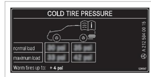
Le tableau de pression des pneus indique la pression de pneu recommandée pour tous les pneus homologués pour ce véhicule et montés d'usine. Les pressions de pneu recommandées sont valables pour des pneus froids pour diff-
