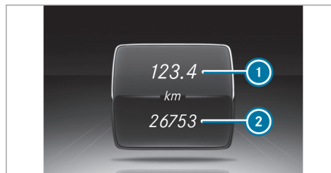
Affichage standard (exemple) ① Distance journalière parcourue ② Distance totale parcourue
