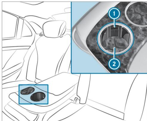
► **Ouverture** : enfoncez le fond du porte-gobelet ② au centre jusqu'à ce qu'il soit verrouillé.
