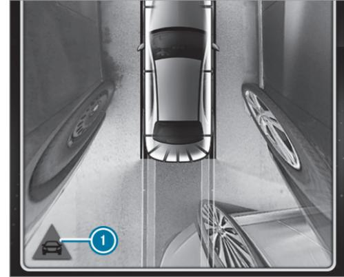
**Véhicules équipés de l'assistant d'angle mort :** la fonction Cross Traffic Alert peut vous avertir des véhicules circulant sur les voies transversales lorsque vous sortez d'une place de stationnement en marche arrière. Pour ce faire, les capteurs radar situés dans le pare-chocs surveillent la zone adjacente au véhicule. Lorsqu'une situation critique est détectée, le symbole ① apparaît sur l'écran média. Si le conduc-
