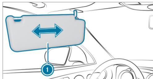
▶ Véhicules équipés d'un pare-soleil coulissant: faites coulisser le pare-soleil ① horizontalement si nécessaire.
