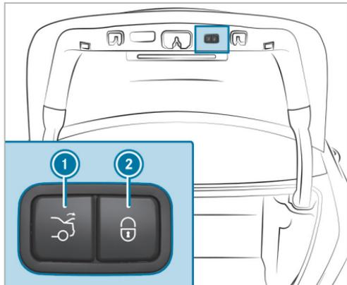
▶ **Véhicules équipés de la fermeture confort du couvercle de coffre** : appuyez sur la touche de fermeture
