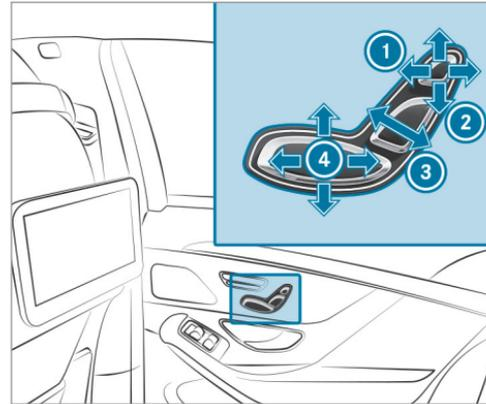
① Hauteur d'appui-tête et approche de l'appui-tête (véhicules équipés de sièges multicontours actifs)
