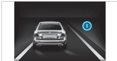
Lorsqu'une intervention de freinage permettant de revenir sur la voie empruntée a lieu, l'affichage ❶ apparaît sur l'écran multifonction.
