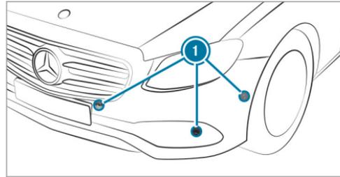
L'assistant de stationnement PARKTRONIC est une aide au stationnement électronique qui fonctionne avec des ultrasons. Il surveille les environs du véhicule à l'aide de plusieurs capteurs ① situés dans le pare-chocs avant et arrière. L'assistant de stationnement PARKTRONIC vous indique de manière optique et sonore la distance qui sépare le véhicule d'un obstacle détecté.
