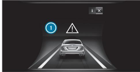
Lorsqu'un freinage autonome ou une assistance au freinage asservie à la situation a été déclenché, l'affichage
