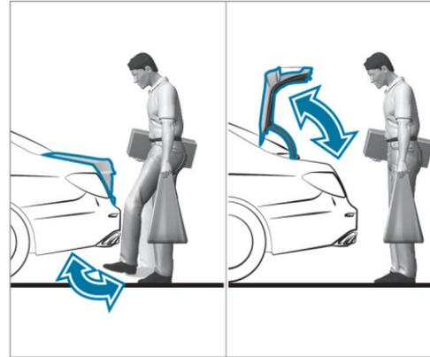
La fonction HANDS-FREE ACCESS vous permet d'ouvrir, de fermer ou de stopper le couvercle de coffre d'un mouvement du pied sous le pare-chocs.
