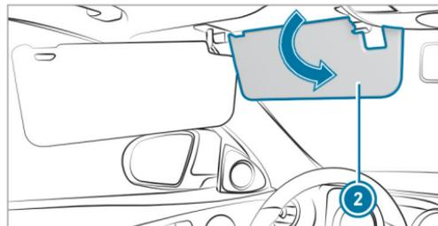
▶ Véhicules équipés d'un pare-soleil additionnel: abaissez le pare-soleil additionnel ②.
