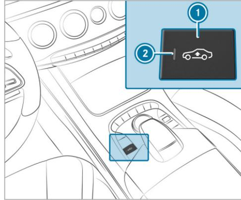
**i** Selon le modèle, la touche ① se trouve sur le panneau de commande situé entre le volant et la porte conducteur.
