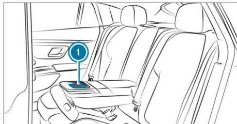
Recharge sans fil à l'arrière sur les véhicules sans tablette arrière MBUX
