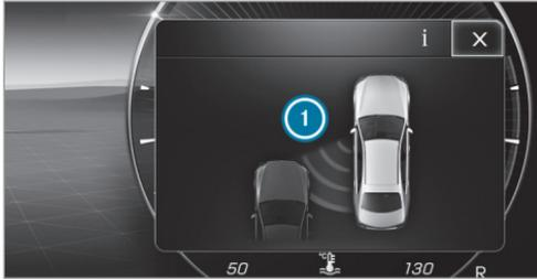
Lorsqu'une intervention de freinage permettant de corriger la trajectoire a lieu, le voyant rouge d'alerte intégré au rétroviseur extérieur clignote et un signal d'alerte retentit. En outre, un affichage ❶ signalant un risque de collision latérale apparaît sur l'écran conducteur.
