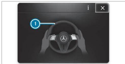
Si le système détecte que le conducteur ne dirige pas lui-même le véhicule ou qu'il lâche le volant pendant une période prolongée, une alerte optique (1) se déclenche. Si le conducteur ne dirige toujours pas activement le véhicule ou ne donne pas de signal de confirmation au système, un signal d'alerte retentit de façon répétée en plus de l'alerte optique.
