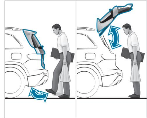
La fonction HANDS-FREE ACCESS vous permet d'ouvrir, de fermer ou de stopper le hayon d'un mouvement du pied sous le pare-chocs. Pour cela, la boîte de vitesses doit se trouver sur **P**.
