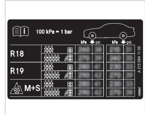
Certains tableaux de pression des pneus mentionnent uniquement le diamètre des jantes (R18, par exemple) à la place des dimensions de pneus complètes. Le diamètre des jantes est indiqué dans les dimensions des pneus et figure sur le flanc des pneus (→ page 387).
