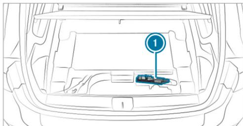
La boîte à fusibles ① se trouve sous le plancher de compartiment de chargement.
