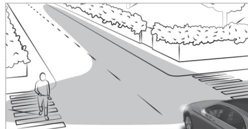
L'éclairage d'intersection augmente considérablement l'angle d'éclairage de la chaussée qu'emprunte le véhicule et permet ainsi de mieux repérer les virages serrés, par exemple. L'éclairage d'intersection ne peut être activé que lorsque les feux de croisement sont allumés.
