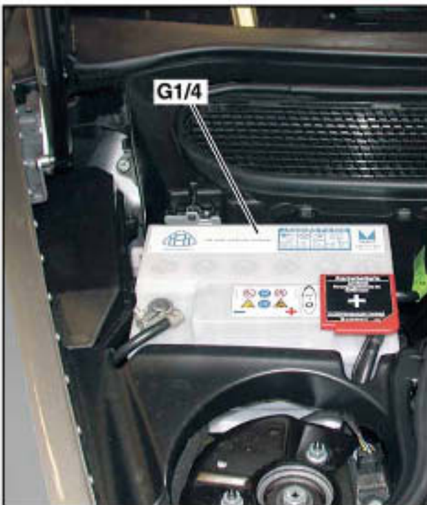
G1/4 Batterie de démarrage dans compartiment moteur, à droite dans sens de marche
