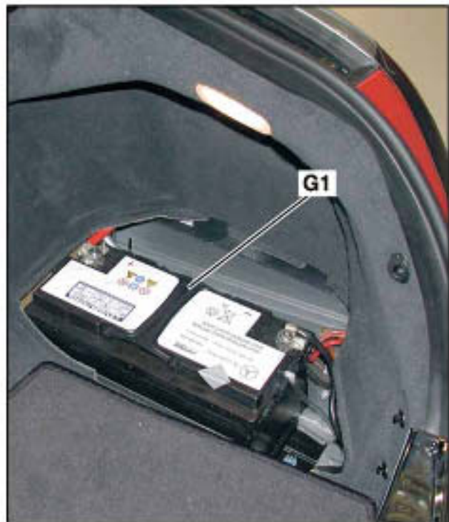
G1 Batterie d'alimentation dans coffre à bagages, à droite dans sens de marche
