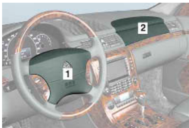
1 Airbag conducteur (à deux niveaux) 2 Airbag passager (à deux niveaux)
