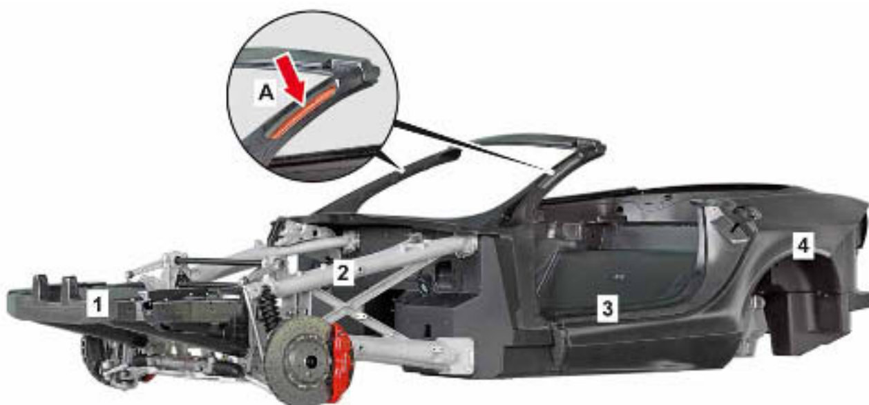
Structure du véhicule roadster SLR McLaren (type 199) avec renfort montants A (A)
