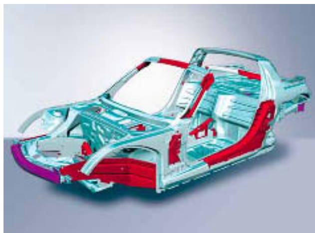
smart roadster : structure de la cellule tridion avec renforts de structure (en rouge)
