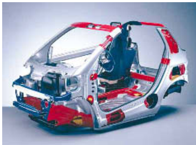
smart fortwo cabrio : structure de la cellule tridion avec renforts de structure (en rouge)
