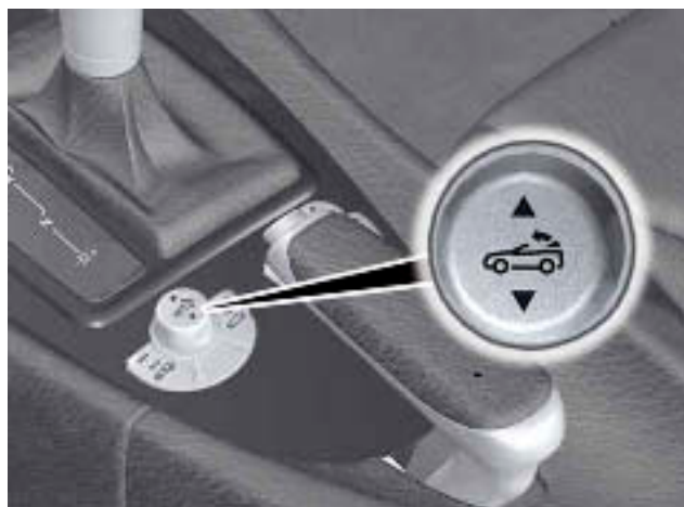
Contacteur de commande toit escamotable Classe SLK (type 171)
